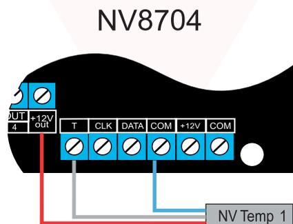
Информацию для подключения нескольких NV TEMP уточняйте в инструкциях к контрольным панелям. Например, к NV 8704 с помощью расширителя NV 8108 можно подключить дополнительно 24 температурных датчиков. На один расширитель NV 8108 до 4 NV TEMP.
